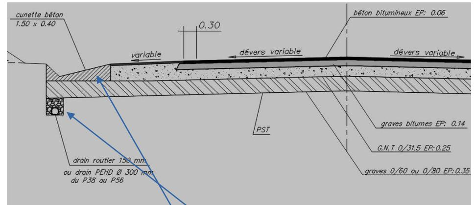
Le décaissement de la chaussée est terminé au déblai 4 (une purge a été nécessaire) et celui du déblai 2 est en cours. Ils anticipent le coulage de la cunette béton, les zones en remblai viendront après.
