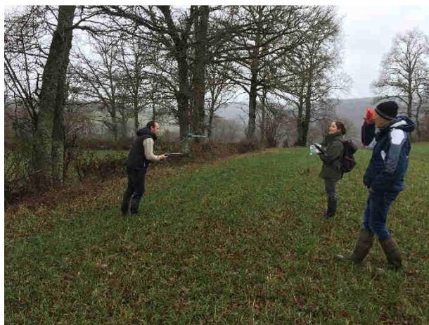
*Mesure de la hauteur de l'arbre à la croix du bûcheron et du diamètre du tronc au compas*
