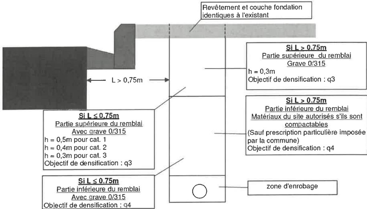
**Schéma n°7 sous chaussée RD cat. 1 niveaux 1 et 2a pour tranchée isolée**
