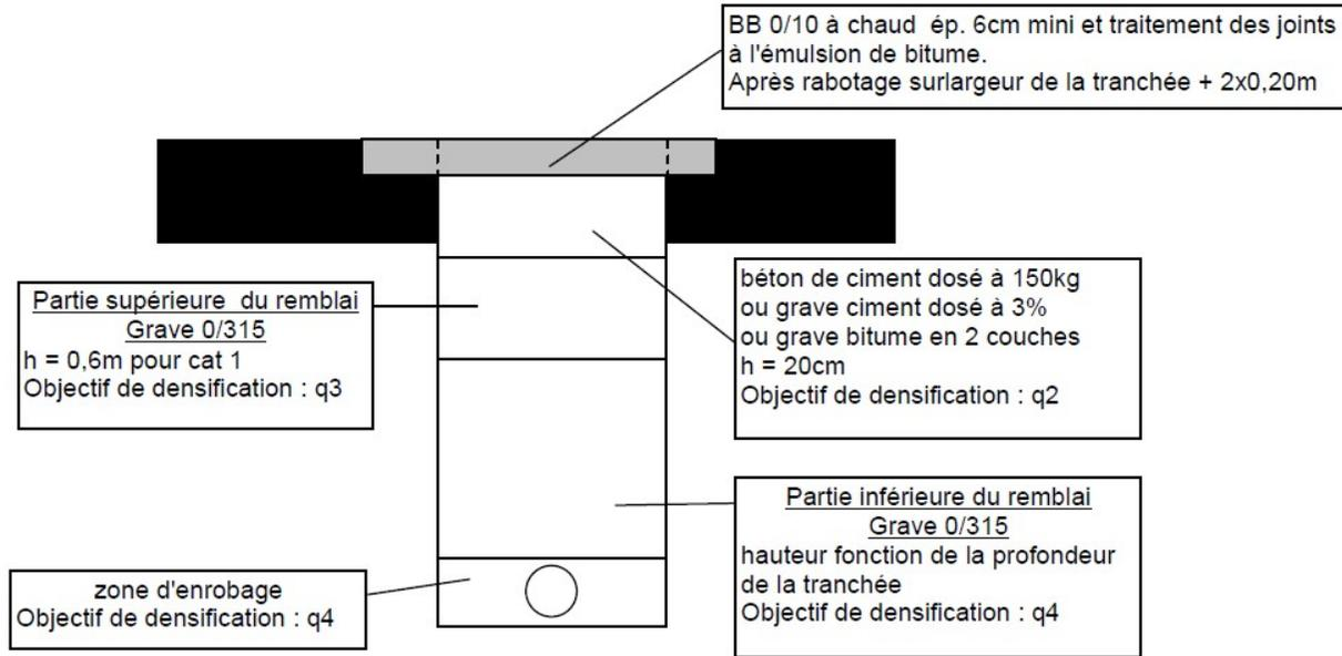
**Schéma n°10 sous trottoir ou sous accotement revêtu RD catégories 1, 2 et 3**
