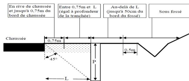
**Schéma n°7 sous chaussée RD cat. 1 niveaux 1 et 2a pour tranchée isolée**
