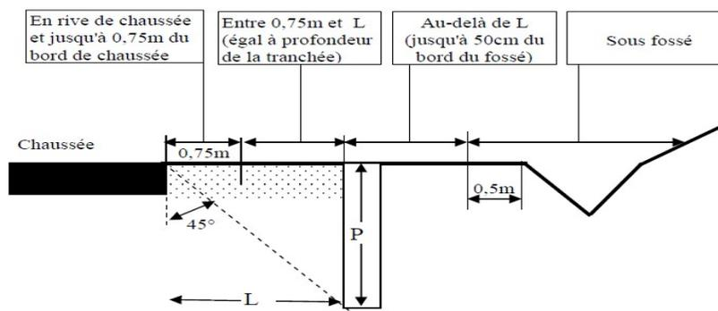
**Schéma n°10** sous trottoir ou sous accotement revêtu RD catégories 1, 2 et 3
