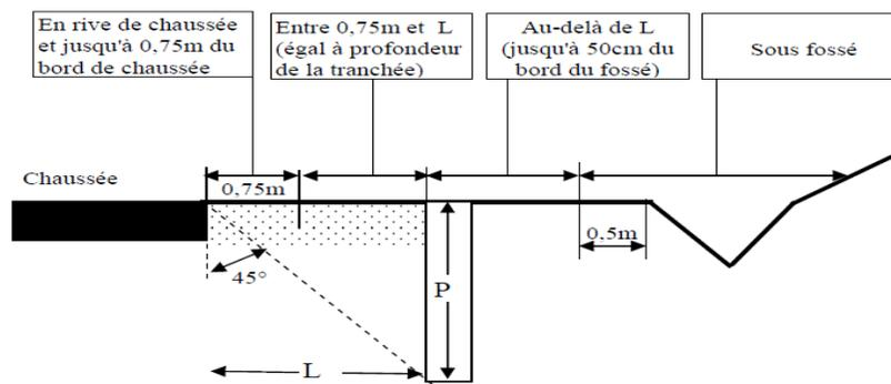
**Schémas 6-1 et 6-2** tranchée sous accotement proche du bord de chaussée des RD des catégories 1,2 et 3
