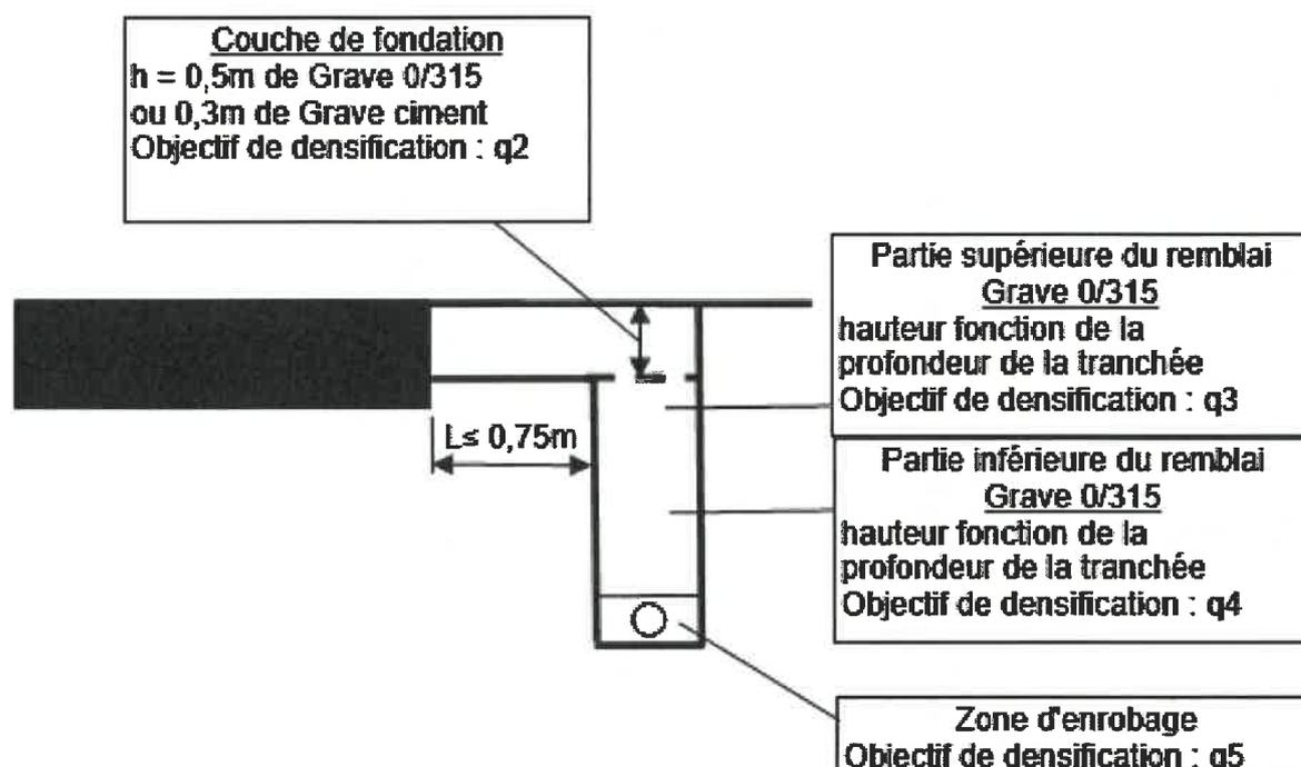
**Schéma n°7** Tranchée isolée sous chaussée de toutes les RD (cat. 1, 2 et (projet à faible impact type branchement particulier)
