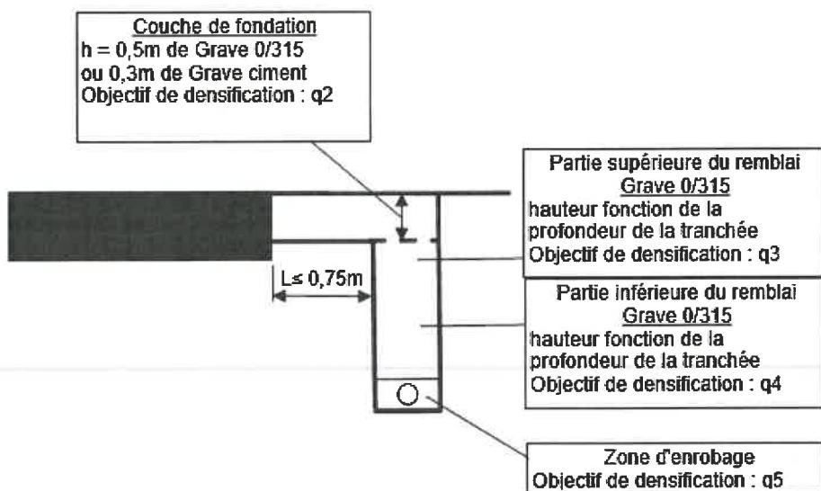
**Schéma n°8 sous chaussée RD catégorie 1 niv.2b, cat.2 et 3 pour tranchée longitudinale**
