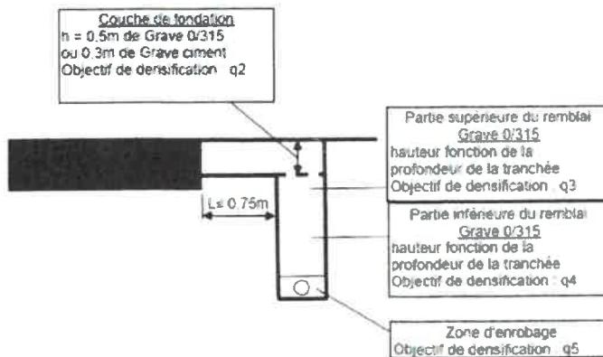
Schéma n°7 Tranchée isolée sous chaussée de toutes les RD (cat. 1, 2 et 3)
