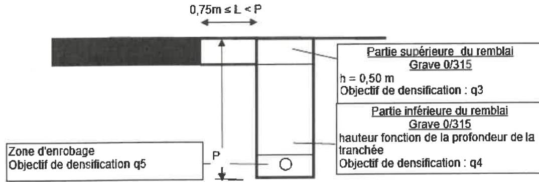
**Schéma n°6-2 tranchée sous accotement située à une distance du bord de chaussée inférieure à 0,75m pour les RD des catégories cat.1, 2 et 3**
