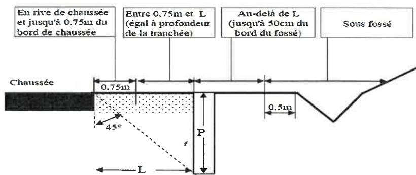
**Schéma n°7 Tranchée isolée sous chaussée de toutes les RD (cat. 1, 2 et 3) (projet à faible impact type branchement particulier)**
