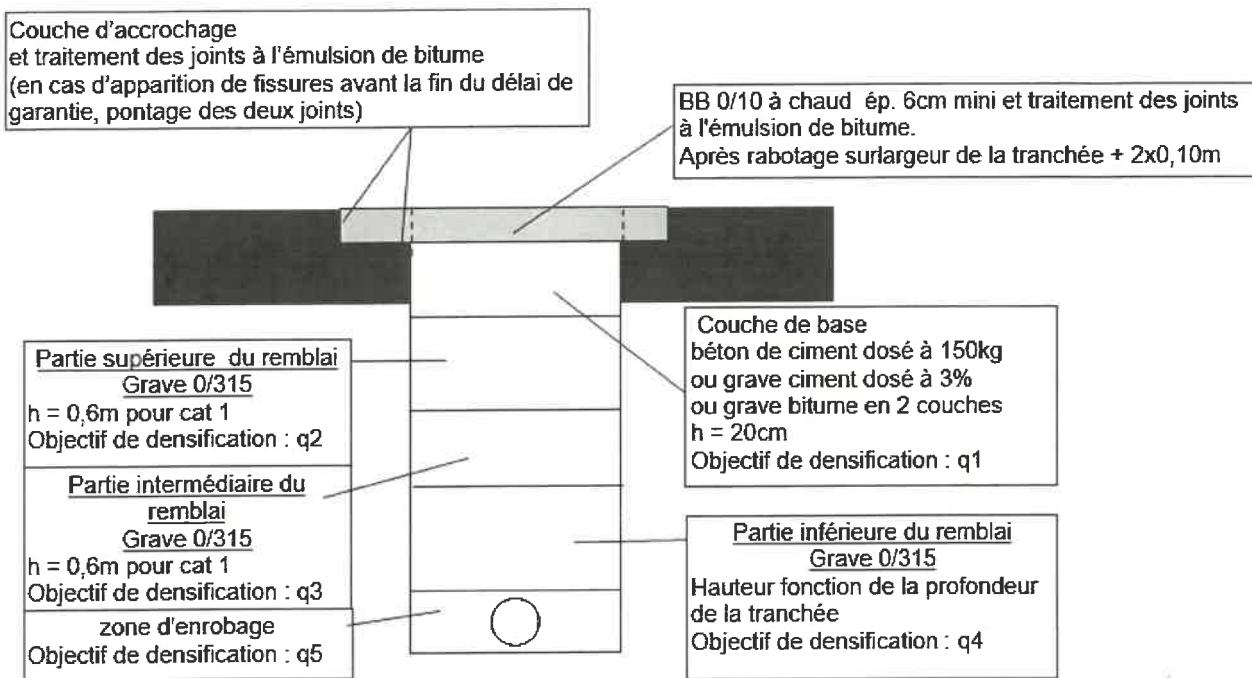
**Schéma 6-1 tranchée sous accotement située à une distance L du bord de chaussée comprise entre 0,75m et P (profondeur de la tranchée) pour les RD des catégories 1,2 et 3**
