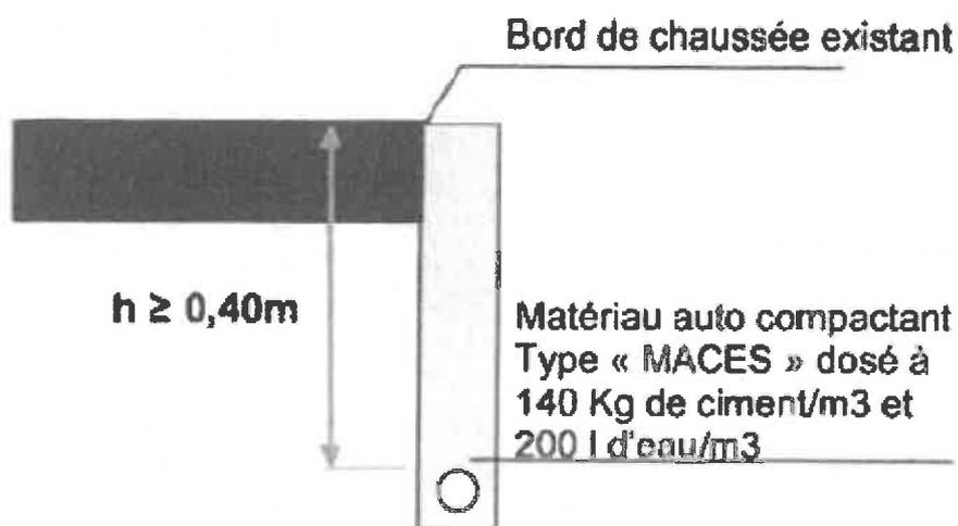
*A la "mauvaise saison", l'alternative à technique est de réaliser la tranchée c les RD de catégorie 1 (schéma n°1-2 chaussée et béton bitumineux chaud)*
