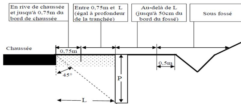
**Schéma n°7 Tranchée isolée sous chaussée de toutes les RD (cat. 1, 2 et 3)
