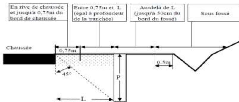
**Schéma n°9 sous chaussée RD catégorie 1 niveau 2b, cat.2 et cat.3 pour tranchée "isolée" et "longitudinale"**
