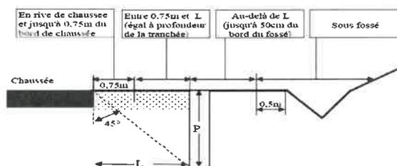
**Schéma 6-1** tranchée sous accotement située à une distance  $L$  du bord de chaussée comprise entre  $0,75\text{m}$  et  $P$  (profondeur de la tranchée) pour les RD des catégories 1,2 et 3
