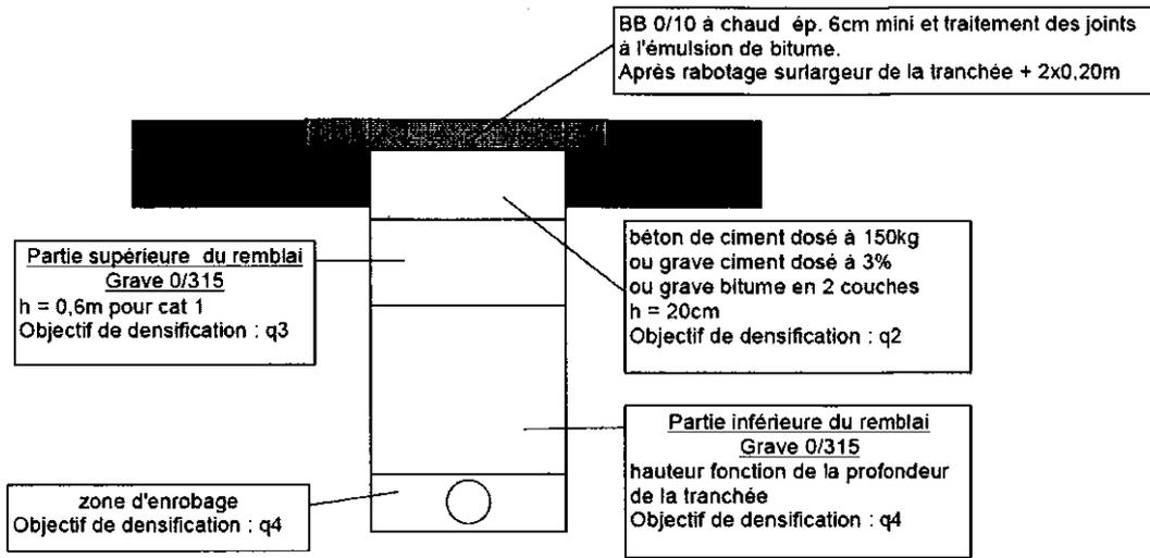
**Schéma n°6-2 tranchée sous accotement située à une distance du bord de chaussée inférieure à 0,75m pour les RD des catégories cat.1, 2 et 3**
