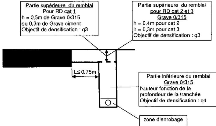
**Schéma 6-1 tranchée sous accotement située à une distance L du bord de chaussée comprise entre 0,75m et P (profondeur de la tranchée) pour les RD des catégories 1,2 et 3**
