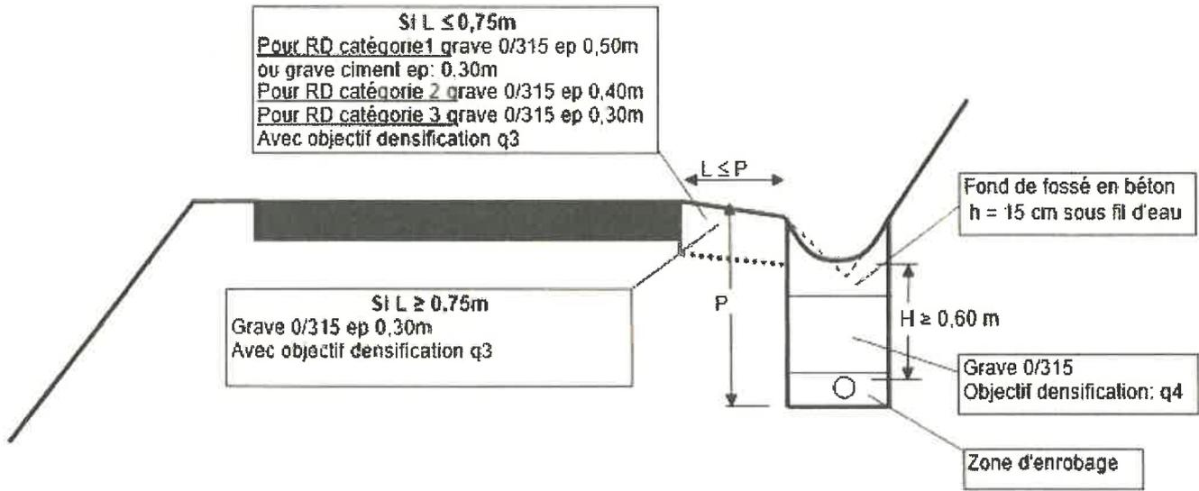
Le maître d'ouvrage du réseau pourra proposer une solution alternative à cette coupe type permettant d'assurer l'étanchéité du fossé après travaux et la réalisation ultérieure des travaux d'entretien du fossé son curage notamment, sans risque de détérioration du réseau mis en place sous le fossé
