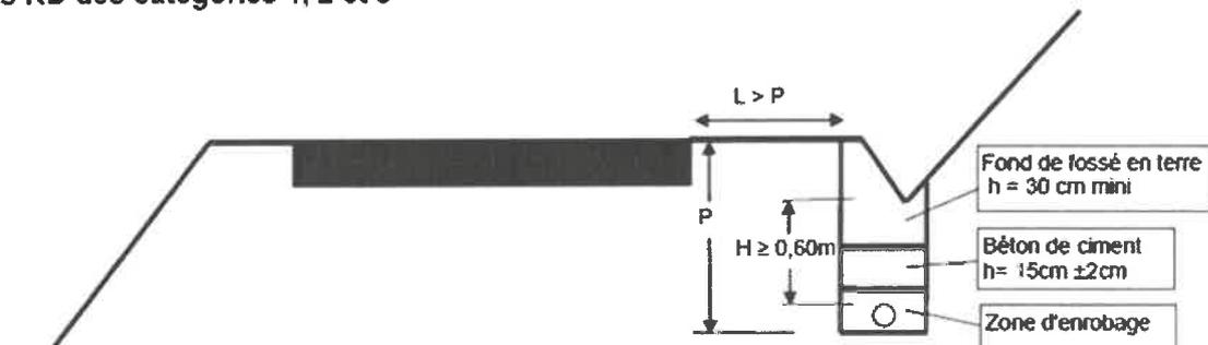
Le maître d'ouvrage du réseau pourra proposer une solution alternative à cette coupe type permettant d'assurer l'étanchéité du fossé après travaux et la réalisation ultérieure des travaux d'entretien du fossé, son curage notamment, sans risque de détérioration du réseau mis en place sous le fossé
