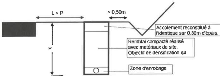
**Schémas 5-1 et 5-2** tranchée sous fossé des RD des catégories 1, 2 et 3
