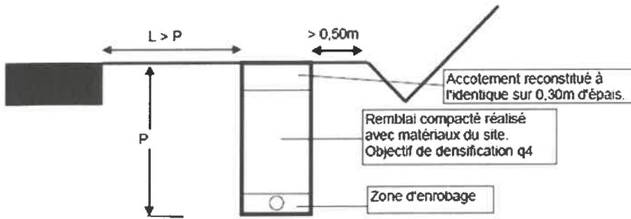
**Schéma 3** tranchée étroite sous accotement des RD des catégories 1, 2 et 3
