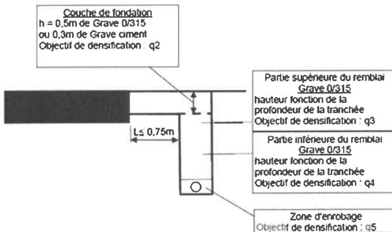
**Schéma 4** tranchée sous accotement non revêtu, éloignée du bord de chaussée et du fossé des RD des catégories 1, 2 et 3
